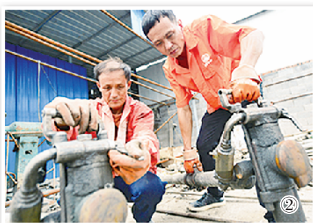
图② 隧道开挖工人李登勤(左)和工友在项目部修理区清理风钻。
