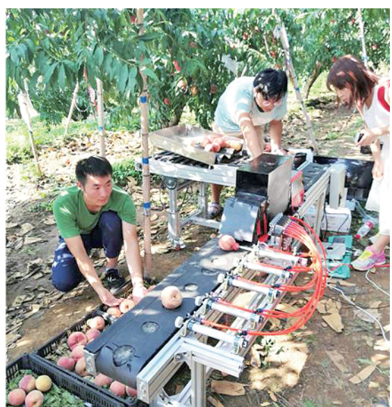
北京工业大学的4名大学生为桃农们开发的“人工智能分桃机”。
