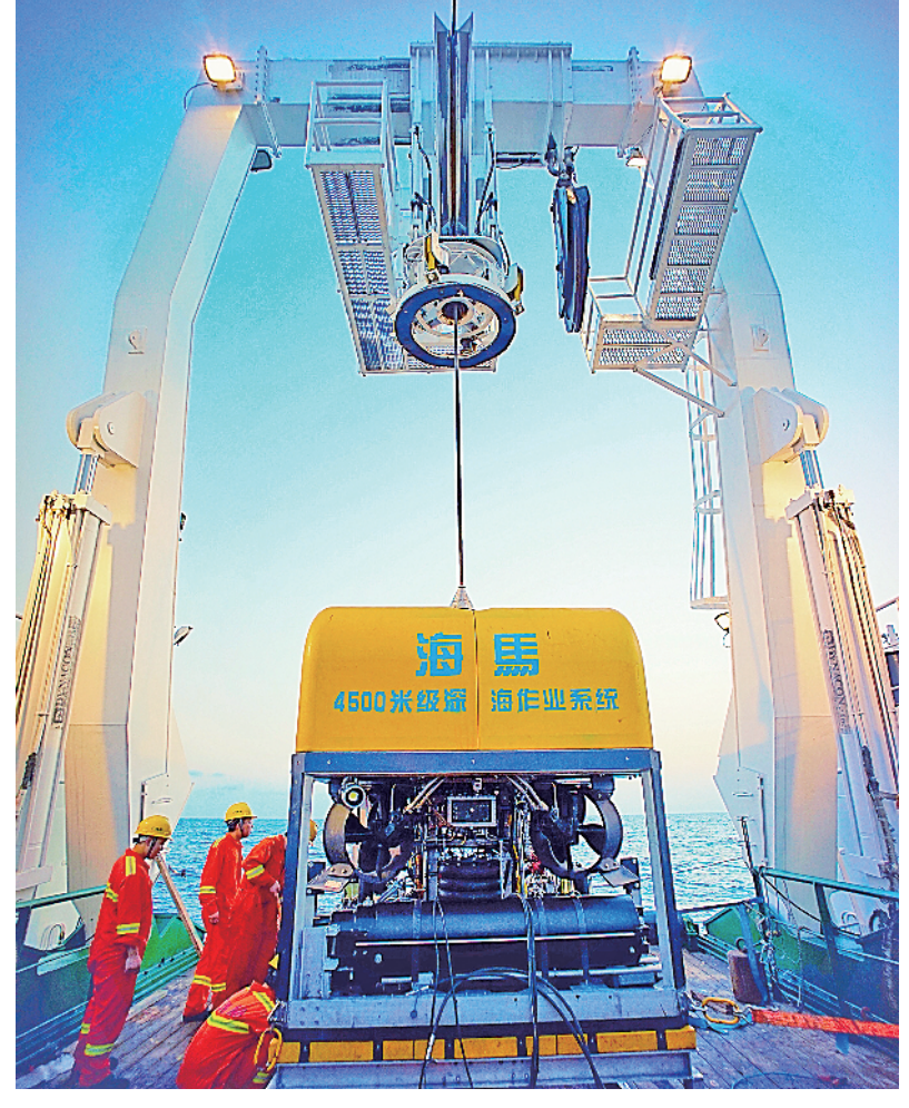
我国自主研发的首台4500米级深海遥控无人潜水器作业系统“海马号”,在海域天然气水合物勘探过程中发挥了重要作用。
