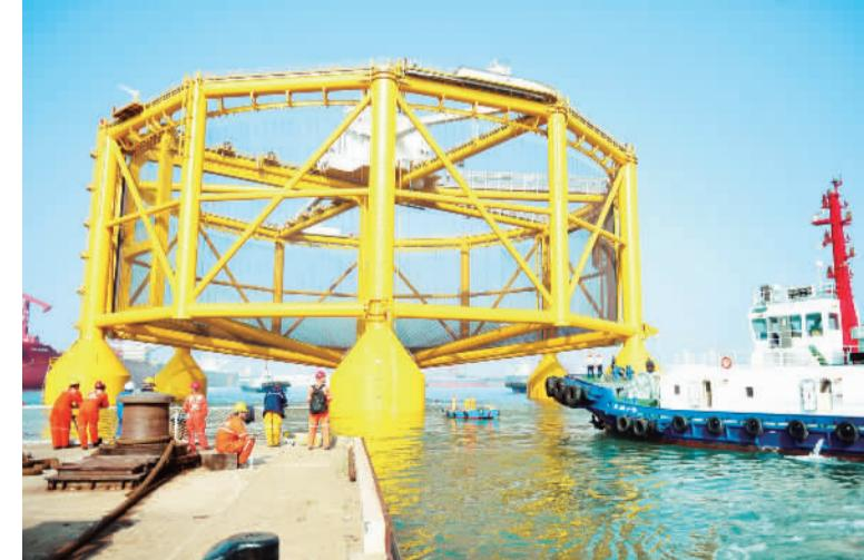
图为中船重工武昌船舶重工研制的大型智能渔场。这是世界首座、规模最大的半潜式深海渔场,是中船重工以军民融合技术引领市场需求、培育经济增长新动能的成功案例。
