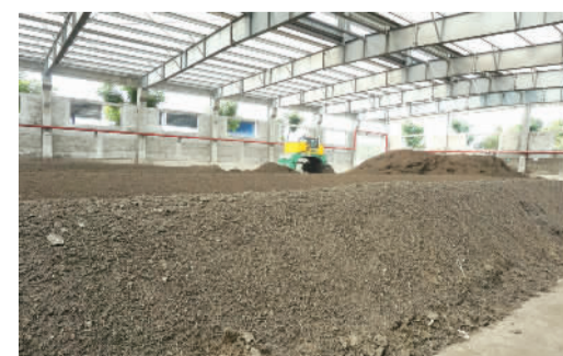
酒厂的有机肥车间里,药渣等废弃物在此堆积存放,并在太阳的直接照射下进行发酵,不产生污水。
