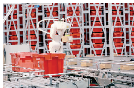
自动包装区域的机器人在为快递包裹贴上电子面单。本报记者 余颖摄
