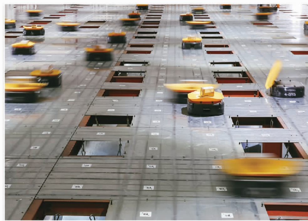
这是义乌中通公司的快递智能机器人分拣系统。这套智能机器人分拣系统已在义乌、天津等地的分拣仓库投入使用，分拣错误率低，效率高，可减少70%的人工。新华社记者 张 铨摄
