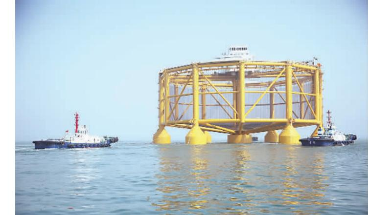
6月14日,世界首座大型半潜式、智能化深海“渔场”——挪威海上渔场养鱼平台,从位于山东青岛黄岛区的武船集团北船重工公司起航奔赴挪威。该“渔场”为全钢网箱结构、全自动养殖装备,抗风能力12级,使用年限25年,一次可实现养鱼量150万条。 张进刚摄
