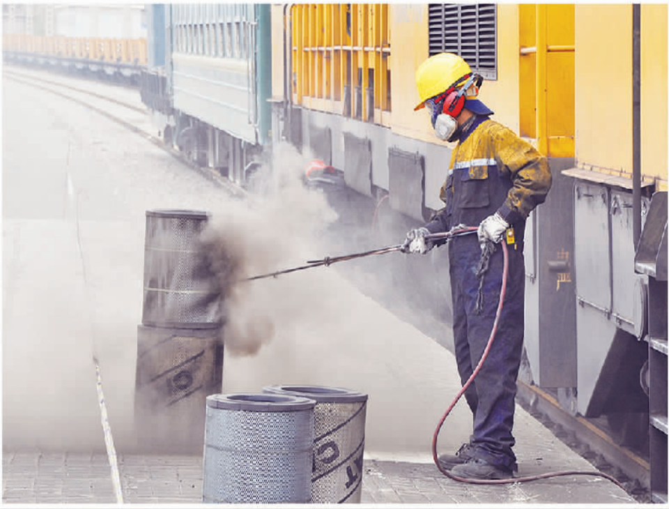
△凌晨4点结束作业，休息几个小时后，打磨工为钢轨打磨车做吹灰保养。
