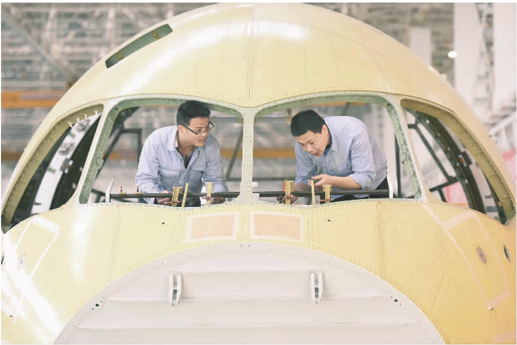
在四川成都,中航成飞民用飞机有限责任公司C919国产大飞机机头生产线上工人在装配驾驶舱风挡。 新华社记者 刘坤摄
