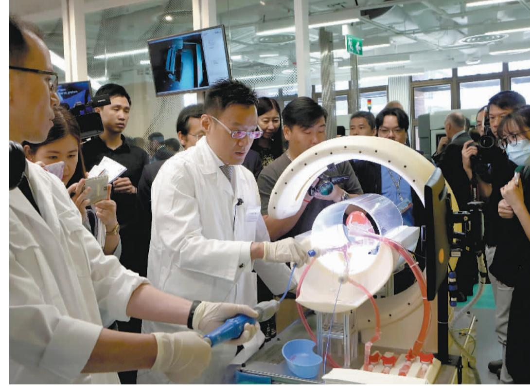
4月19日，香港理工大学三维打印(3D打印)技术中心实验室开幕，该校与一所公立医院合作利用三维打印技术研发的导管主动脉瓣植入术模拟系统也同时启用。图为技术人员示范利用三维打印技术研发的导管主动脉瓣植入术模拟培训系统。
