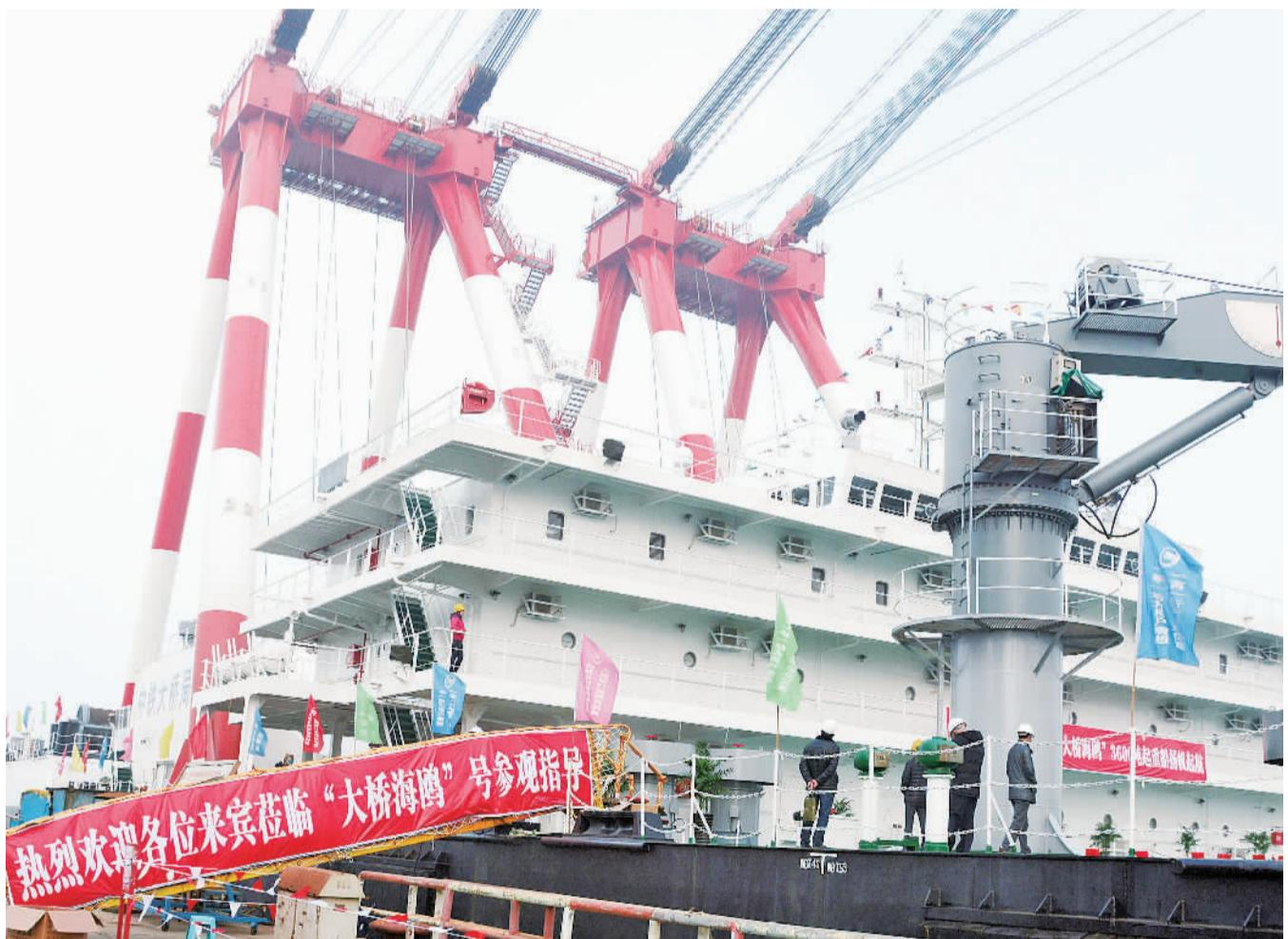
1月9日，“大鹏海鸥”号起重船停泊在码头。当日，由中铁大桥局投资建造的“大鹏海鸥”号起重船在青岛西海岸新区交付使用。这艘起重船起重量3600吨，主钩最高起升高度距水面以上110米，是国内起重量最大、起升高度最高的起重船。
