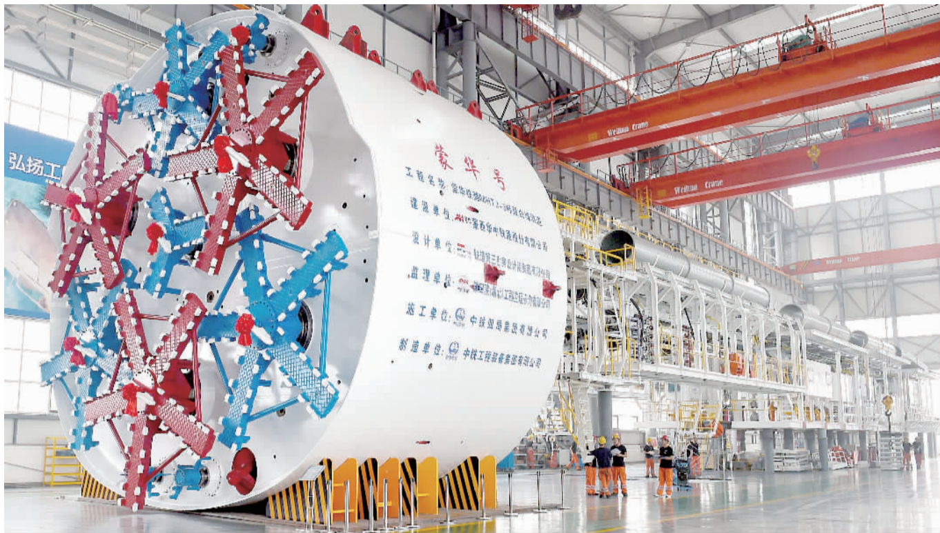
全球首台“马蹄形”刀盘盾构机的成功研制,标志着我国已经拥有具有自主知识产权的超大断面马蹄形盾构设计和施工技术,实现了异形盾构装备的自主化和智能化,为我国高端设备进军国际市场提供了强有力的工程示范。新华社记者 李博摄
