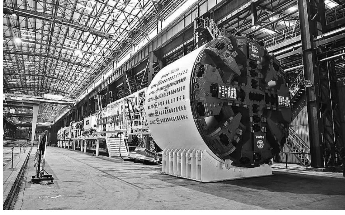
11月26日,我国首台使用国产主轴承的再制造盾构在合肥顺利下线,并通过中国质量认证中心验收。图为当日通过验收的再制造盾构。余纪伟摄
