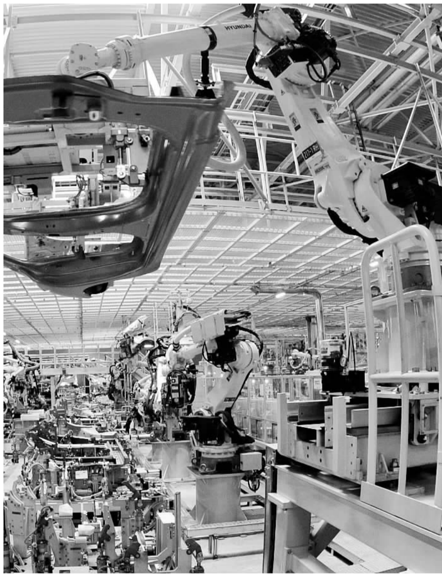
前不久，北京现代沧州工厂生产的首款车型VERNA下线并上市，标志着京津冀协同发展战略实施以来，体量最大的项目正式竣工投产。沧州工厂是北京现代首个京外工厂。图为机器人在该工厂焊接车间生产线上工作。新华社记者 车宇摄
