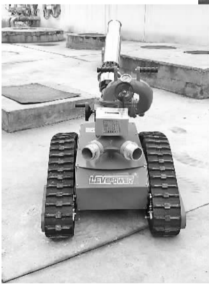
下图 用于消防作业的消防机器人,喷水量是每秒40升。 本报记者 姜天骄摄
