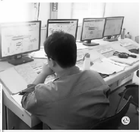
图② 赣锋锂业中控室内，技术人员正在监管锂辉石转型焙烧生产线。
