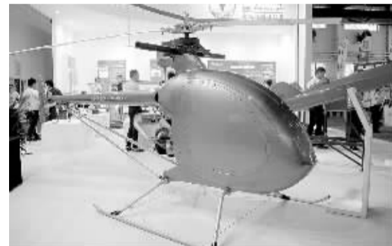
图为一款能在海拔3000米以下的合适高度以巡航速度飞行的无人直升机,能进行扫描式搜索。
