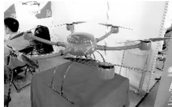
图为用于城市消防应急救援的无人机,可执行监控火情、找出高温火点等应急救援工作。
