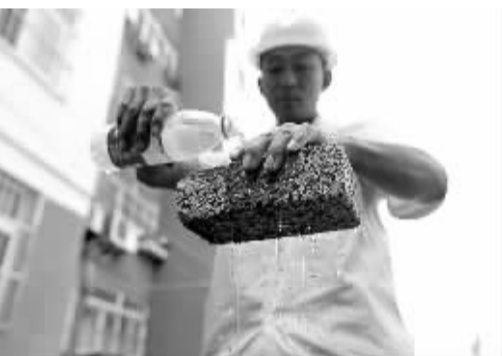
↑ 工人正在铺设透水砖。 ↓ 工人展示透水结构的雨水下渗功能。
