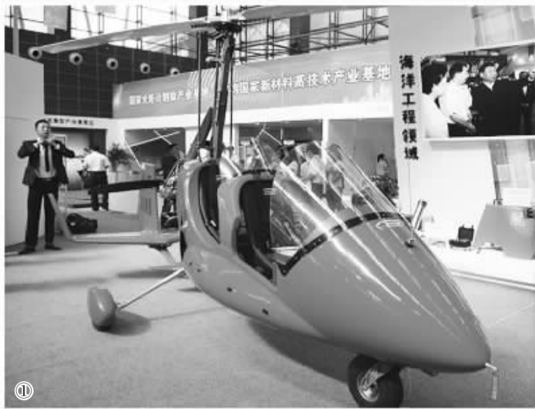
图① 宝钛集团控股的欧亚公司研发的世界首架钛合金骨架旋翼机“欧亚”,最高航速可达每小时200公里,续航能力600公里。
