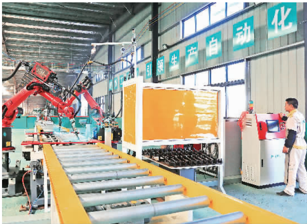
上图 江西广昌县工业园区企业——江西志特现代建筑科技有限公司全智能焊接机器人正在进行焊接铝模板作业。该企业与南昌航空大学等多家单位合作,研发出多套全智能自动化生产设备,可实现24小时全自动化焊接、冲孔等作业,不仅提高了作业精度和生产效率,同时也节约了人工和劳动力成本。本报记者 李树贵摄
