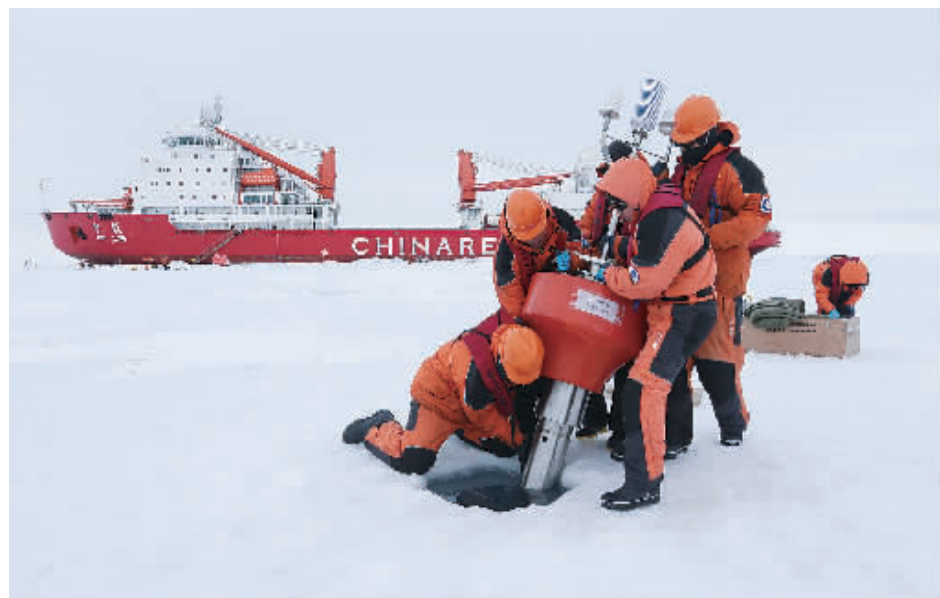
这是考察队员在短期冰站布放我国自主研发的冰基拖曳式海洋剖面浮标(8月18日摄)。8月20日,中国第七次北极科学考察队结束了全部六个短期冰站和一个长期冰站的作业,开始返回低纬度海域继续进行北冰洋大洋作业。新华社记者 伍岳摄
