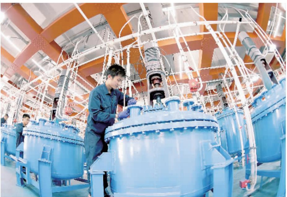
今年以来,河北唐山建华科技发展有限公司深度开发纳米科技新材料石墨烯在复合材料、生物医学、国防军工、航天航空、电子光学等领域的下游应用产业,致力于打造世界一流石墨烯产业集群。公司与北京交通大学、北京航空航天大学、中国工程院等紧密合作,建立了院士工作站、省级石墨烯科技企业孵化器、京津冀石墨烯产业发展联盟等,依托石墨烯的科研成果,自主研发了具有国际先进水平的国内首家年产百吨级石墨烯生产线。图为公司员工在调试自主研发的石墨烯生产设备。
