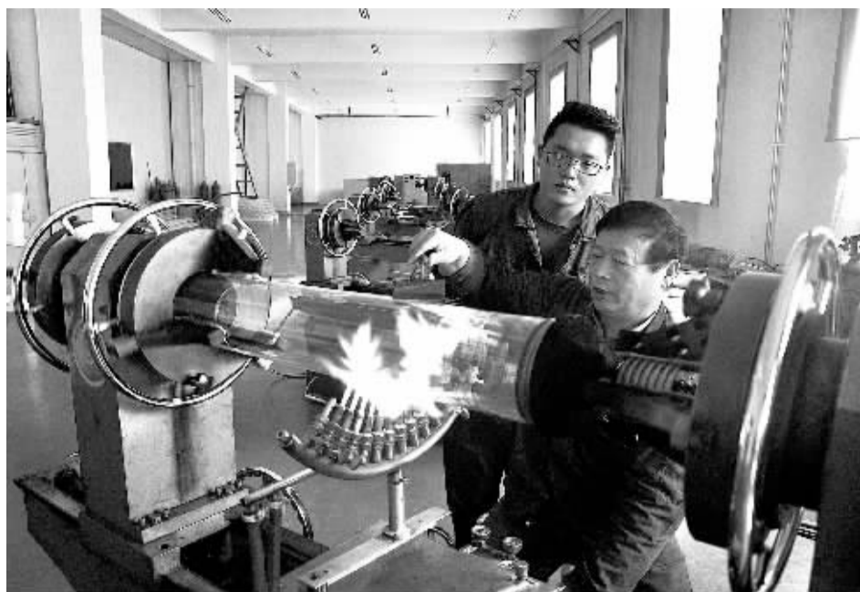
兰州新区大成科技公司生产车间里，工人对太阳能光热组件进行封装。
