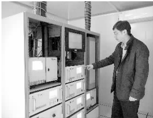
下图 为更加精细化管理，天津市在各乡镇街、工业园区和重点区域设置271个空气质量自动监测站。图为天津南区一个站点，环保监测人员正在查看污染物数据。 本报记者 杜芳摄
