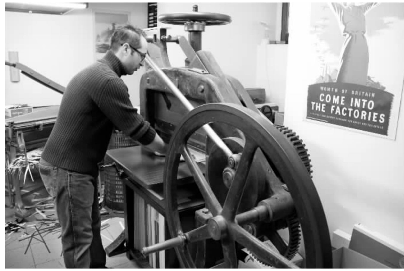
日前,在意大利东海岸城市里米尼,修书匠保罗·卡斯蒂廖内展示手摇切纸机。意大利现有手工修书店大约100家。意大利的修书店在中世纪时期是装订书籍的唯一选择,这与不少欧洲国家一样。随着工业时期的到来,大批量的书籍装订逐渐由工厂承包。电子数码技术普及后,政府、律师等昔日的大客户转向无纸化办公,修书店如今完全走上精品道路。同在意大利东海岸城市里米尼的梅伊·阿戈斯蒂诺和保罗·卡斯蒂廖内是手工修书行的一老一少。他们是暗自较劲的对手,也是惺惺相惜的朋友,因为他们对修书这门手艺有着同样的坚守。 新华社记者 葛晨摄
