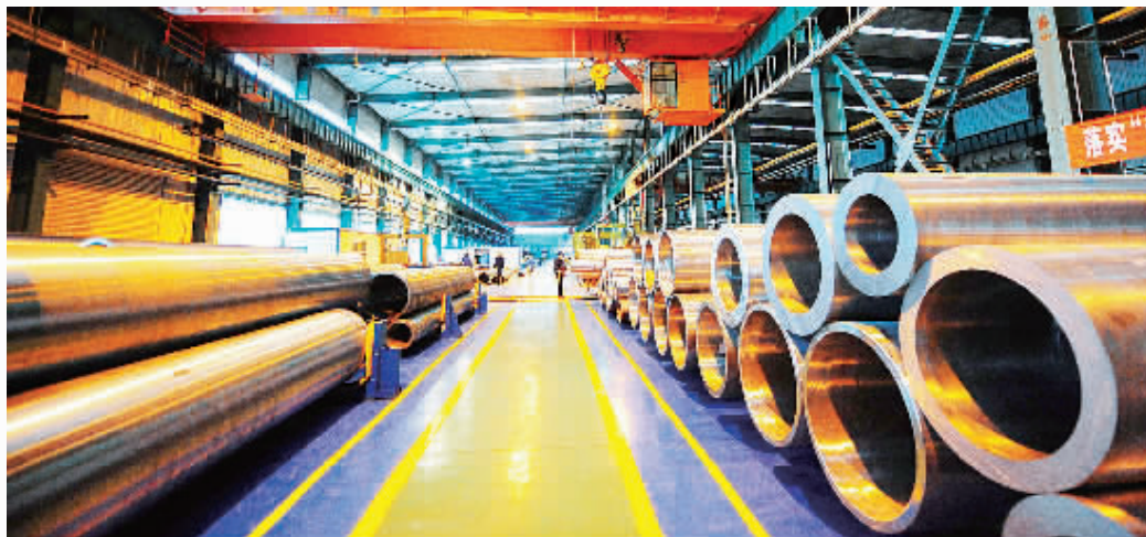
内蒙古北重集团的职工在无缝钢管生产装配线上作业。
