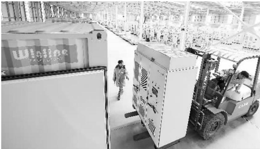
位于河北南和经济开发区的永联科技南和有限公司，工人在装配1兆瓦箱式逆变器。该公司主要从事光伏逆变器、储能变流器等产品的研发、生产、销售和服务。去年投资16亿元在南和县建设全国规模最大的光伏逆变器生产基地。
