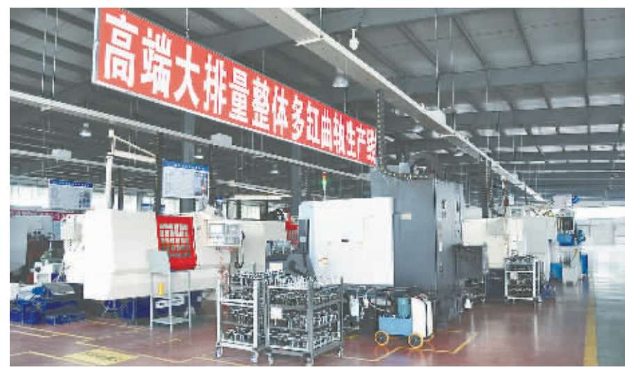
青岛德盛机械公司高端大排量整体多缸曲轴生产线,该生产线属单元式控制智能化生产线。
