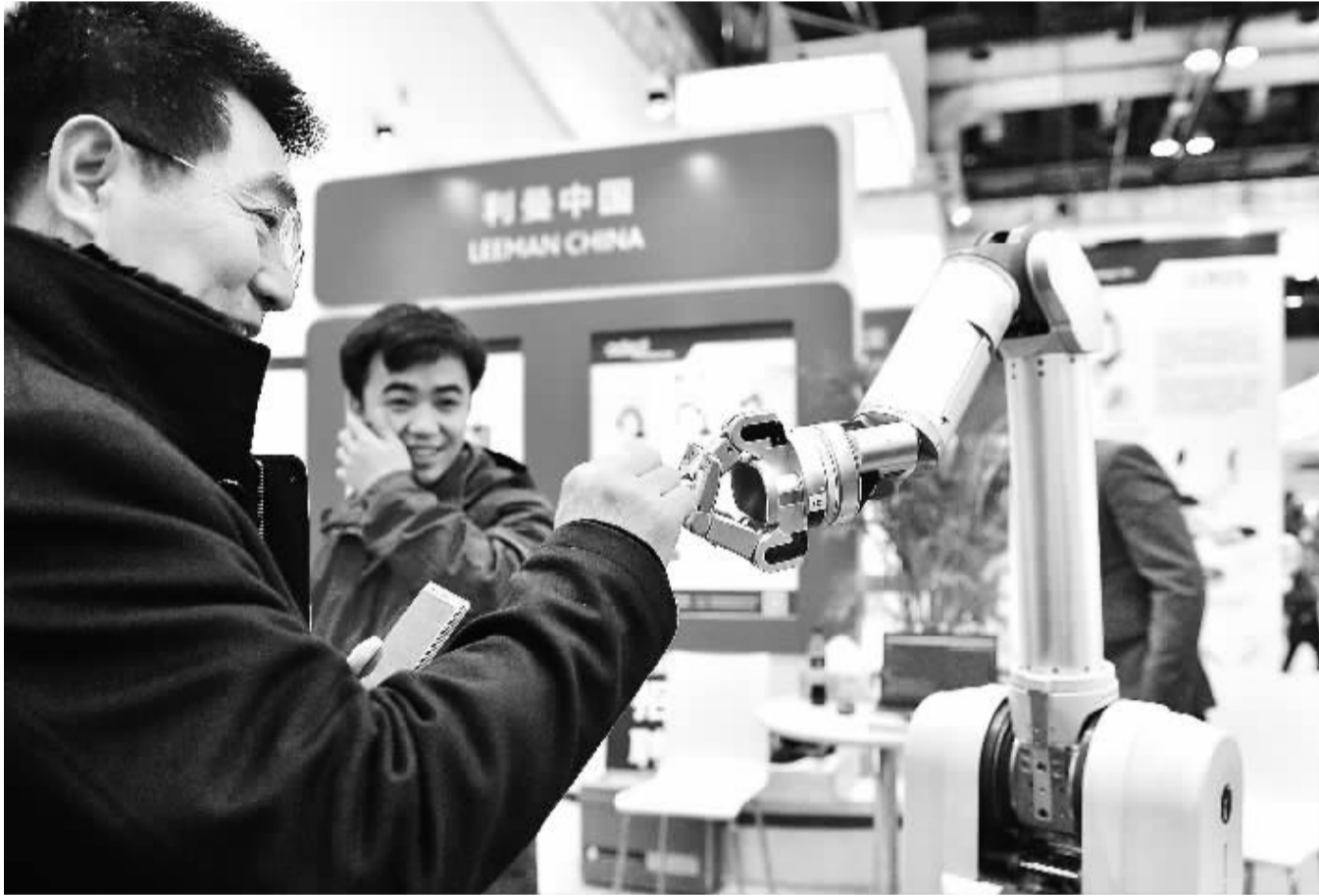
11月24日,在2015世界机器人博览会上,利曼中国的wam是一款轻型高度灵活的带反力驱动机器人手臂。
