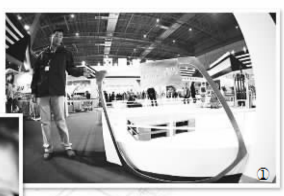
图① 北京航空航天大学参展人员介绍用3D打印技术打印的C919机头主风挡的窗框。
