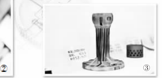
图② 上海航天技术研究院参展人员展示用3D打印技术制造的高性能碳纤维接头。
