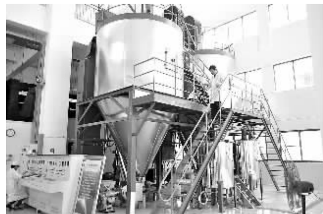
厦门蓝湾科技有限公司和国家海洋三所经过多年艰苦研究,成功实现高纯度硫酸氨基葡萄糖规模化、低成本、绿色生产。图为蓝湾制备喷雾干燥设备。
