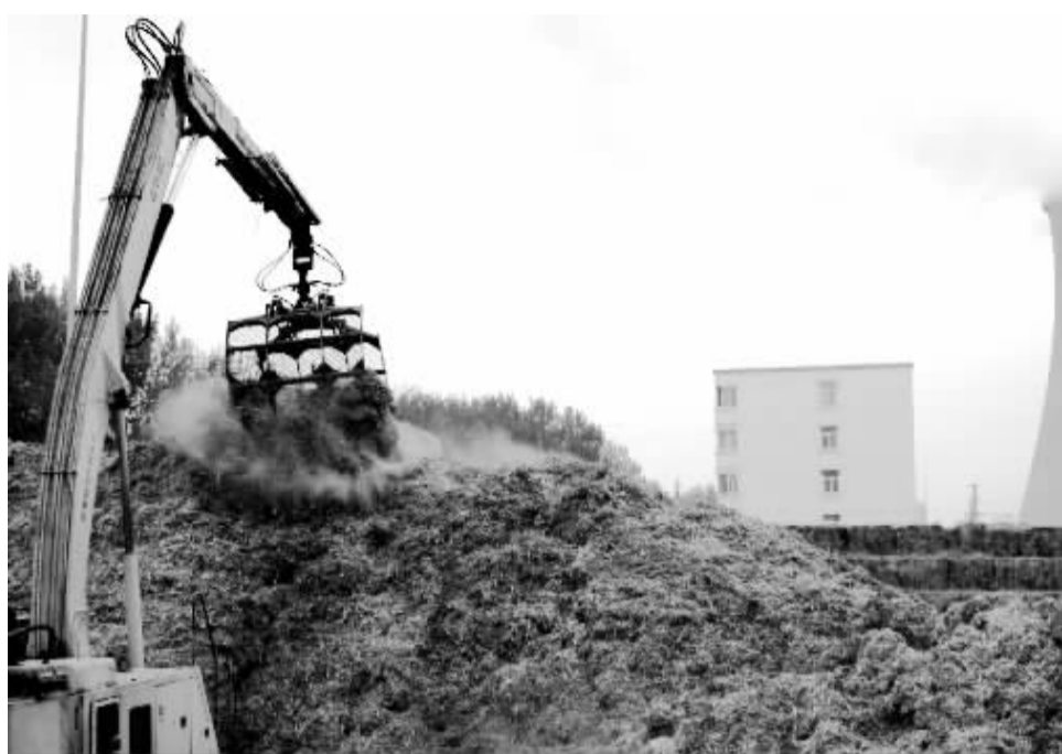
上图 10月27日,国能集团河北南宫市生物发电厂正在调运秸秆用于发电。该厂年利用秸秆约30万吨,相当于节省标准煤10万吨,减排二氧化碳18万吨。
