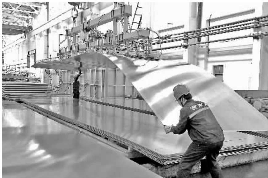
图为中铝西南铝生产的全铝运煤车用铝合金预拉伸板。李影摄
