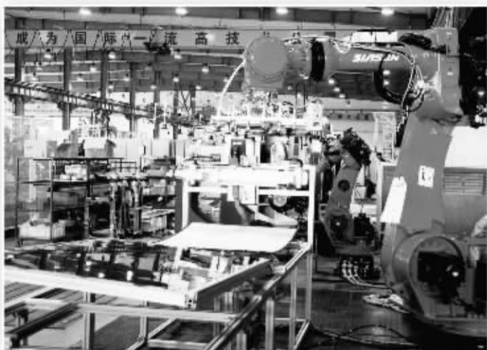
△新松公司研发的液晶屏视觉装配机器人系统，可以用有“视力”的机器人对液晶面板实现翻转、搬运。
