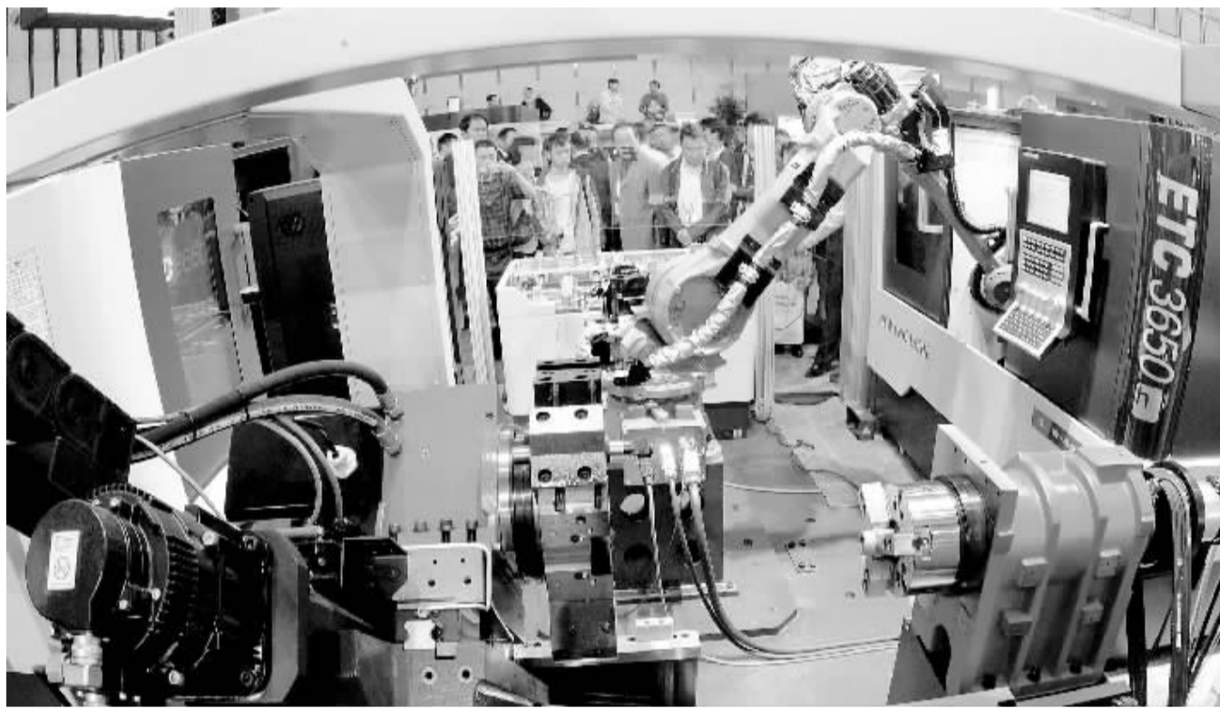
东北地区拥有大连造船、沈阳机床、中国一重等一批“国宝级”企业,这些企业是参与国际产能合作的重要支撑。图为沈阳机床生产的柔性自动加工单元设备。
