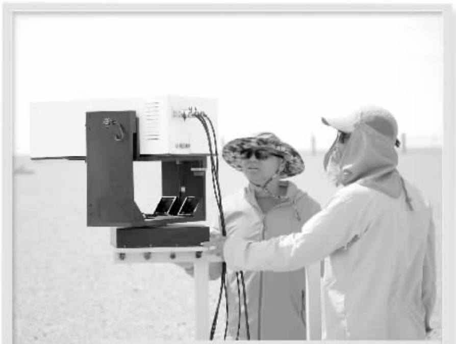
▲ 近日,由中国遥感卫星辐射校正场管理办公室组织的卫星辐射定标外场试验队在自动化观测基地场区进行地表反射率和大气光学特性参数全自动测量。
