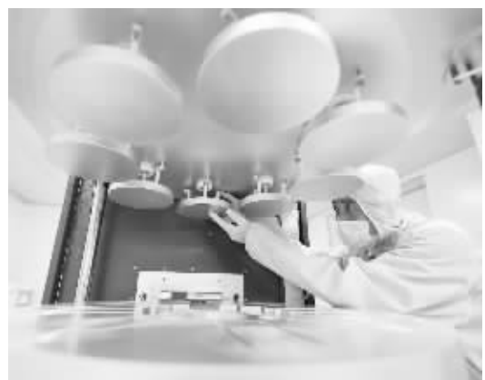
工作人员在组装6英寸大规模集成电路专用薄膜设备(PECVD设备)。
