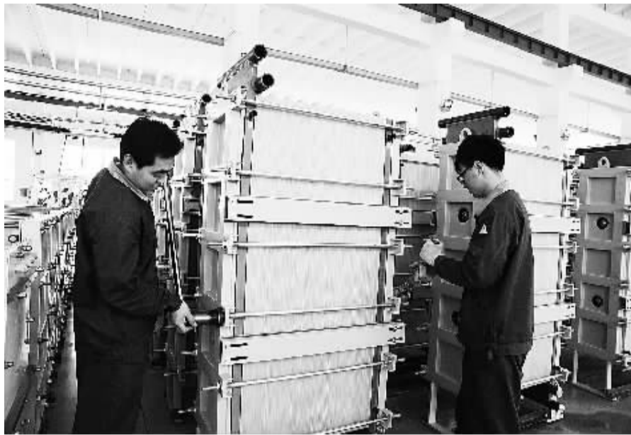
山东天维膜技术有限公司生产车间里,工作人员正在安装膜设备。(资料图片)
