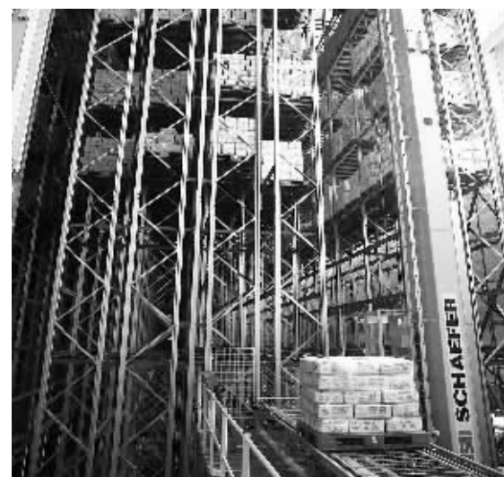
“华东一号”仓库托盘货架在出货(6月17日摄)。据介绍,该仓库坐落在上海松江,规划有10万立方米实时有效动态容量,50万种SKU(库存量单位)的管理能力及20万的日订单处理能力。由于引入了智能系统,仓库拣选方式已从“人找货”变为“货到人”。 新华社记者 裴鑫摄
