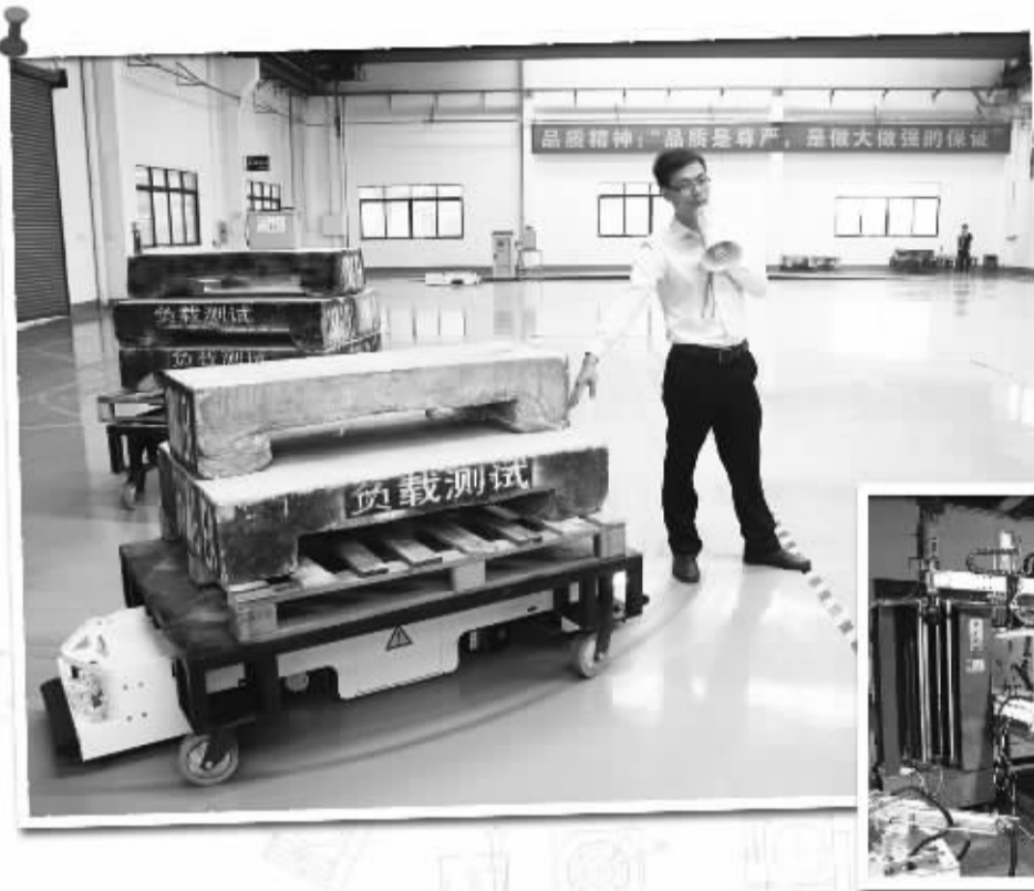
左图 在佛山嘉腾机器人公司的车间,智能搬运机器人正在进行负载测试。
