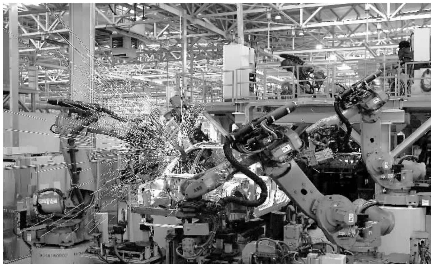
图为北汽股份公司北京分公司，机器人在流水线上焊接自主品牌绅宝汽车。
