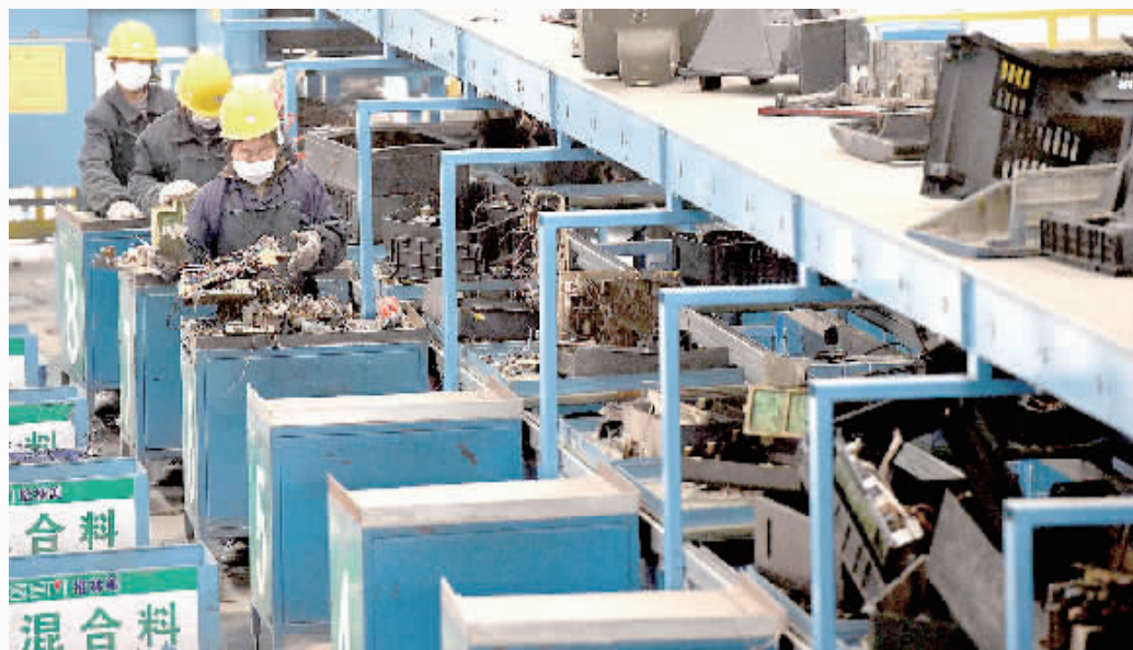
在河南兰考的再生资源循环产业园内,工人将废旧汽车和废旧家电分拣、拆解、加工处理,变成铜、铁、铝等再生资源。
