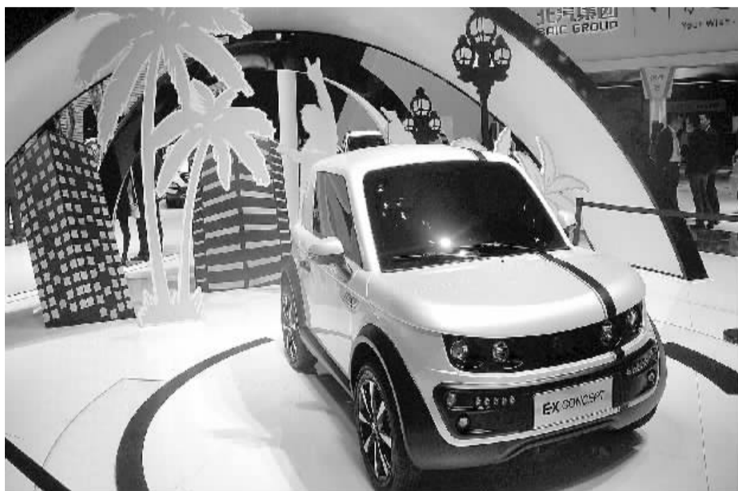
北汽集团展出的“EX CONCEPT”,该车最高车速为150kmh,等速(60kmh)续航里程为260km,慢充时间为3小时,快充至80%电量为0.5小时。
