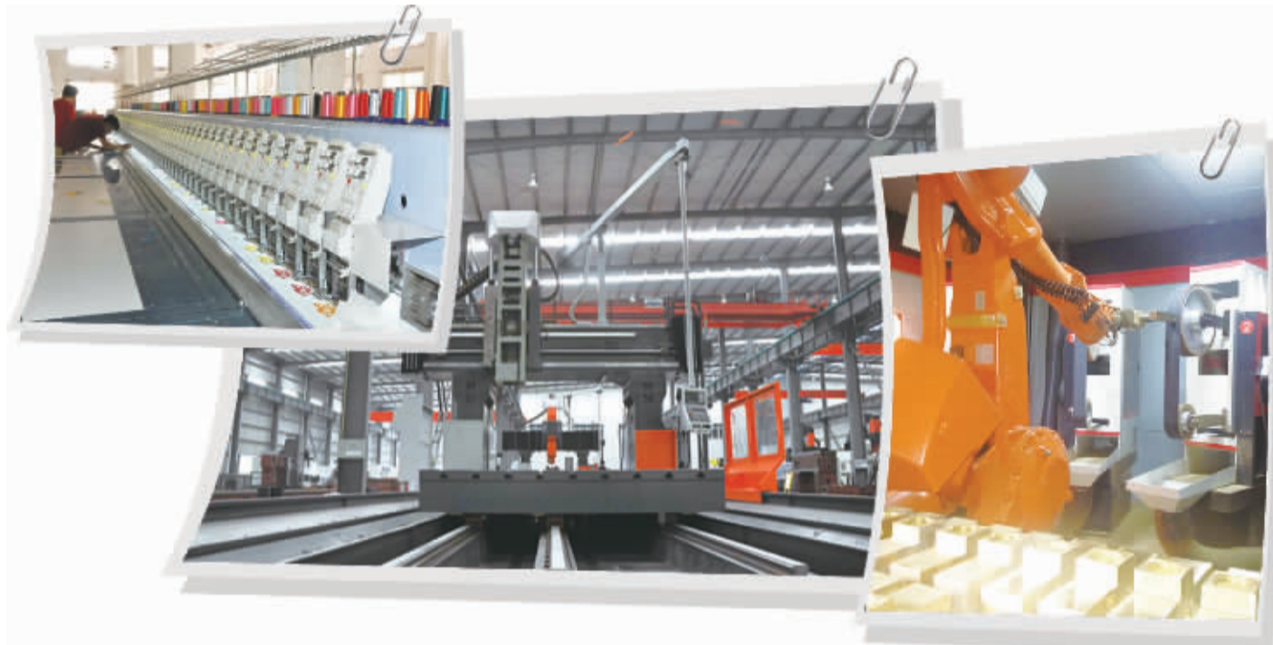
左图:福建永信数控科技股份有限公司自主研发的高速平绣机,60余个针头可同步完成刺绣任务。中图:福建省嘉泰数控机械有限公司“数控一代”产品生产线。右图:在中宇建材集团有限公司,数控抛光机械手在对水暖产品实施自动抛光生产。
