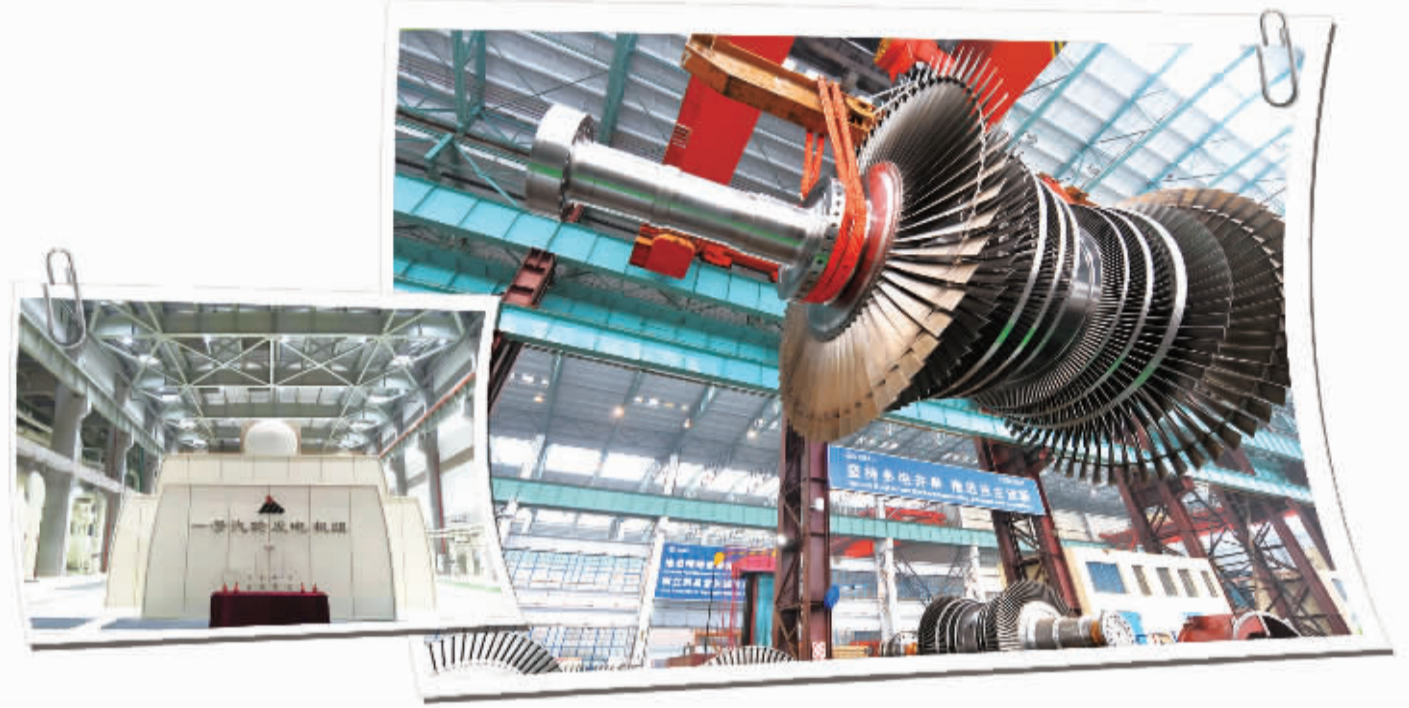
左图 东方电气集团东汽有限公司制造的重庆神华万州电厂1号机组。(资料图片) 右图 东方电气集团东汽有限公司制造的世界最大功率的中广核台山1750MW核电汽轮机。(刘岗摄)
