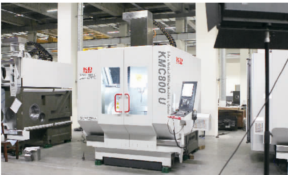
辽宁省科技创新重大专项“智能化五轴系列立式车铣复合加工中心”。
