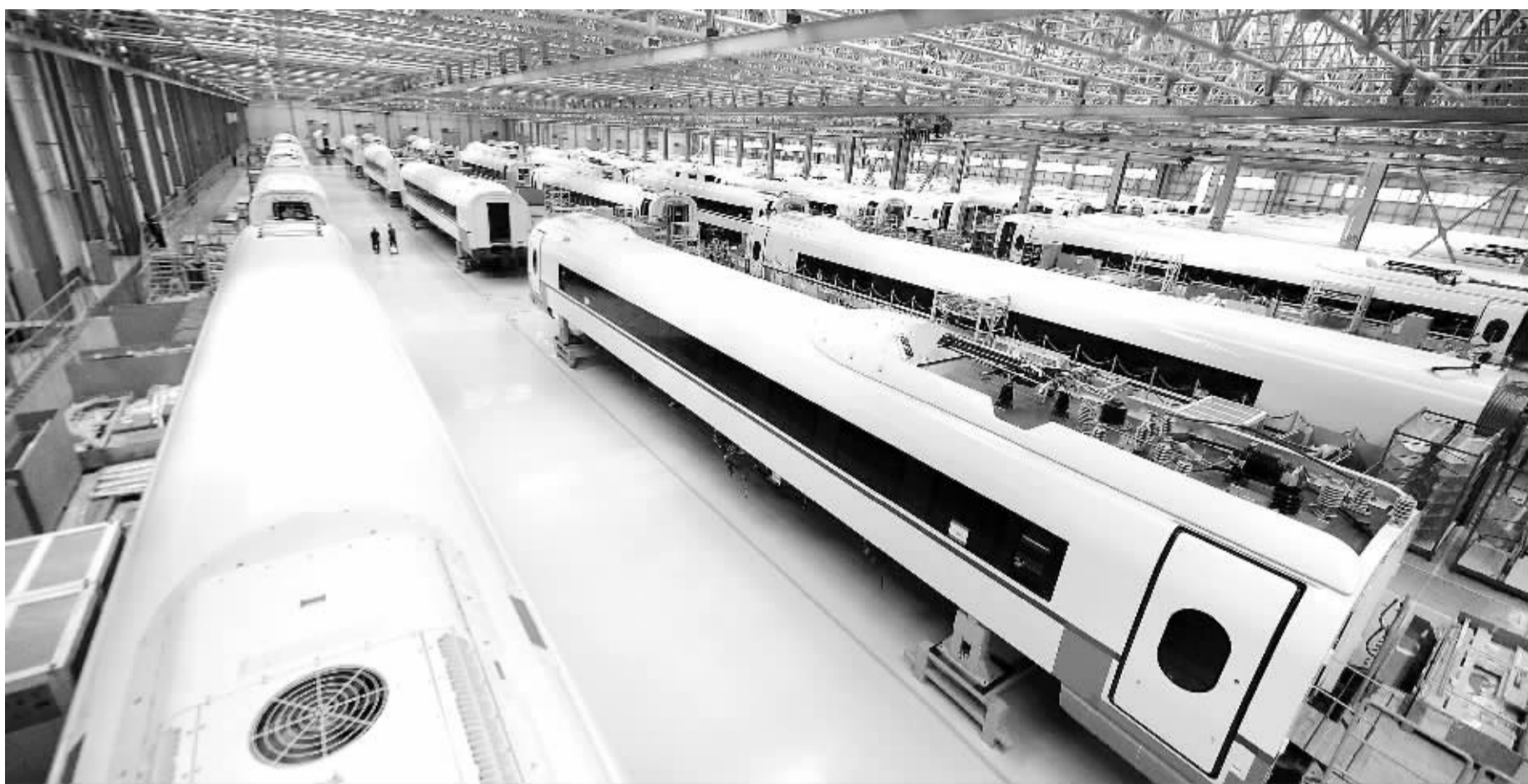
这是中国北车长客股份公司装配车间内待组装的用于京沪高铁线的CRH380BL新一代高速动车组(2011年6月11日报)。
