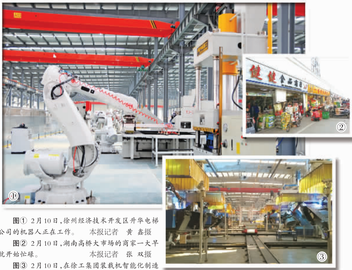
图③ 2月10日,在徐工集团装载机智能化制造基地的车间里,24台机器人正在焊接铲斗。本报记者 黄鑫摄
