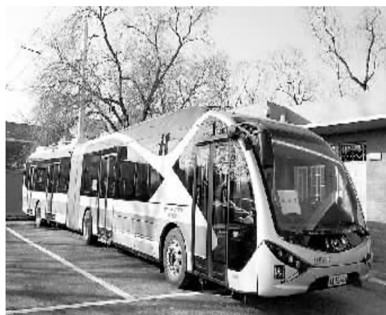
安定门“快三”公交场站内停放的“电鲑鱼”,是拥有与动车相似车头和18米流线型修长车身的双源无轨电车。 本报记者 杨学聪
