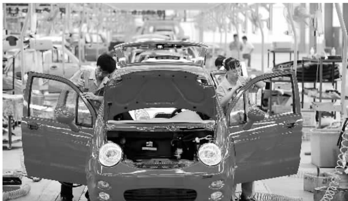
山东维动新能源汽车有限公司生产车间，工人正在组装低速电动车。
